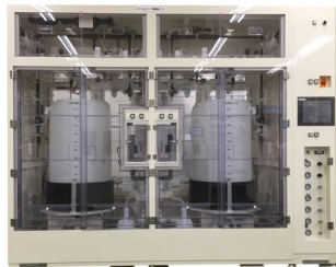
Sistema di diluizione e dosaggio dei prodotti chimici
